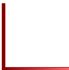
L profil 30x30x2mm slitina AlMgSi 0,5
