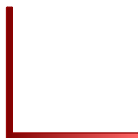
L profil 25x25x2mm slitina AlMgSi 0,5
