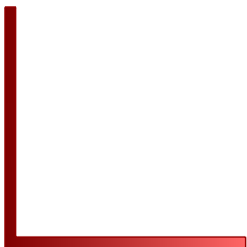
L profil 45x45x2mm slitina AlMgSi 0,5
